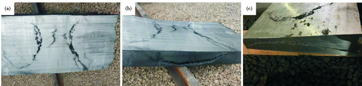
图 2 解剖开裂钢锭的形貌图: (a) 横截面, (b) 钢锭表面, (c) 纵截面
